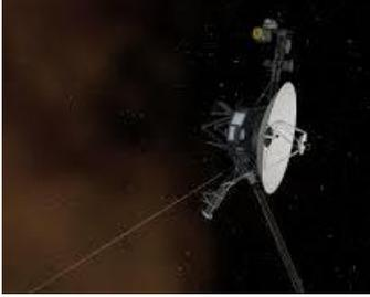
في 5 سبتمبر 1977 أطلقت الناسا (NASA) المسبار فوياجر 1 (Voyager 1) من فلوريدا إلى زحل والمشتري. يمتلك هذا المسبار مولدات من النظائر المشعة لانتاج الطاقة الحرارية التي يتم تحويلها إلى طاقة كهربائية، تحتوي هذه المولدات على البلوتونيوم 238 ( $^{238}_{94}\text{Pu}$ ) الذي يتفكك مصدرا إشعاع  $\alpha$ .
